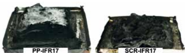
2. ábra 17% IFR-t tartalmazó egyszerű PP keverék és önerősített kompozit égési maradékai
